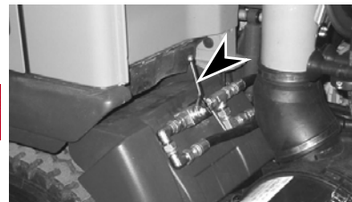
VANNE DE COMMANDE DE LA RAMPE DE PULVÉRISATION HP 'OFF'
