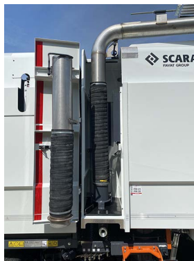
Skříňka s horním výložníkem První nástavec uložený na dveřích skříňky
