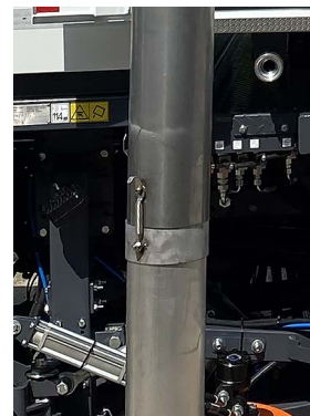
Druhý nástavec připojený s pružinovými západkami na místě
