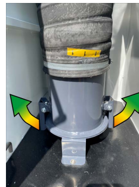
Otevřete odpružené spony, abyste se uvolnili ze záslepky
