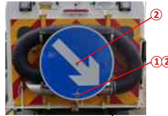
PANNEAU DE CIRCULATION FIXÉ SUR LES SUPPORTS DU FLEXIBLE MOBILE
