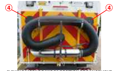
FLEXIBLE MOBILE DANS SA POSITION DE RANGEMENT
