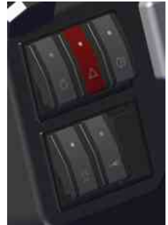
Panneau des contacteurs de phares monté sur le tableau de bord.
