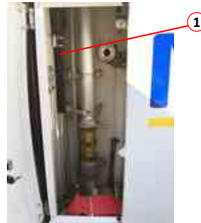
Illustration du compartiment avec le racleur, la lance manuelle, le goulot de remplissage du réservoir d'eau et le tuyau vertical en option.
