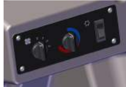
Steuerungen der Kabinenheizung mit Klimaanlage
