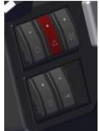
Am Armaturenbrett montierte Lichtschaltertafel
