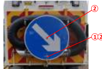
VERKEHRSSCHILD AN DER HANDSAUGSCHLAUCH-VERWAHRVORRICHTUNG BEFESTIGT
