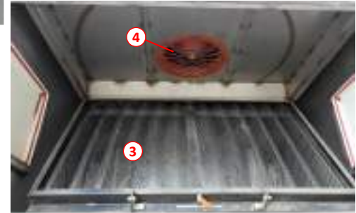
Zum Reinigen abgesenktes Sieb
