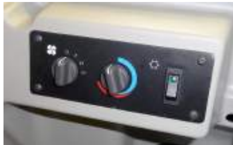
Controlos de aquecimento da cabina com ar condicionado
