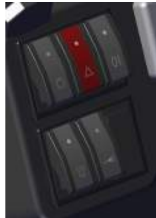
Panel de Interruptores de luz montado no painel de instrumentos
