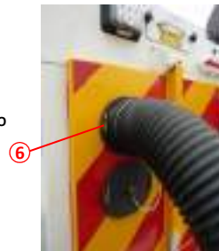
MANGUEIRA DE ASPIRAÇÃO NA POSIÇÃO INSTALADA
