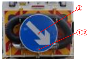
SINAL DE TRÂNSITO FIXO AOS SUPORTES DE ACONDICIONAMENTO DA MANGUEIRA MÓVEL
