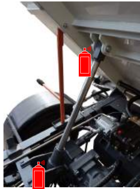
LUBRIFICAÇÃO DO ELEVADOR DA TREMONHA
